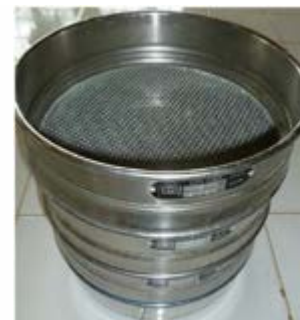
Figure 7. Trois Tamis en inox superposés
